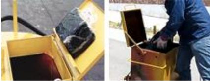
Las grietas deberán ser rellenadas con selladores para grietas Estimación del Material Requerido: Utilice el siguiente cuadro como una guía para estimar los requerimientos de material (basados sobre kilogramos de material necesario para 30.48 metros de grietas):
