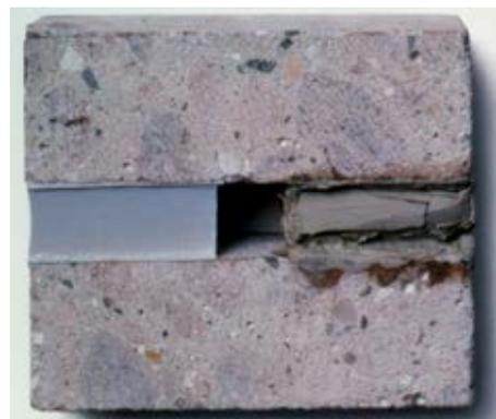
Trascurridos 100 días (2,500 horas) de exposición a radiación UV y luego de los ensayos de envejecimiento acelerado y estabilidad al calor, el sellante de uretano (derecha) se deteriora, mientras que el sellante de silicona (izquierda) permanece inalterado.
